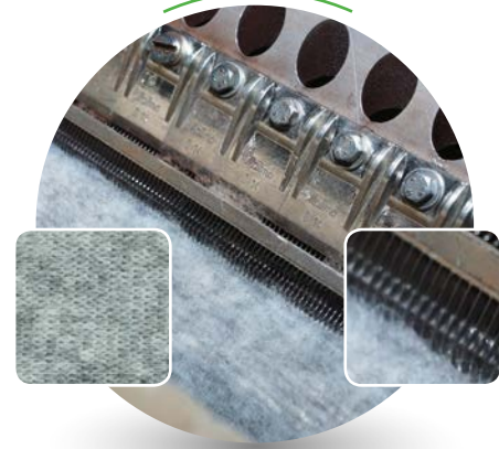
Mittels Vermaschung durch Wirknadeln Multiknit: Qualitex/Caliweb
