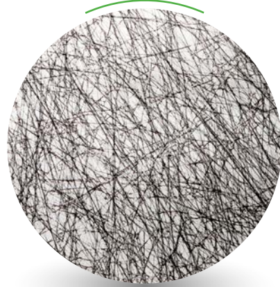
Verfestigung durch Kalandrieren und/oder Durchströmen mittels Schmelzklebefasern (BiKO oder PP)
